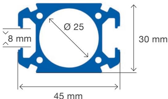
El diseño de la sección del perfil **PPS SQ** incluye una ranura que permite el uso de accesorios (tuercas, etc.) **compatibles con los perfiles más comunes del mercado.**
