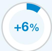
PARA UN CORRECTO USO DE LAS HERRAMIENTAS, ES NECESARIO AJUSTAR ESTA PÉRDIDA DE ENERGÍA. POR EJEMPLO: EL AUMENTO DE 1 BAR PRODUCE UN CONSUMO ADICIONAL DE ENERGÍA DEL 6%.
